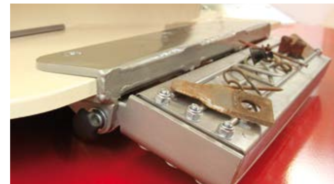
Neodymový, silný magnet v perfektním umístění.
