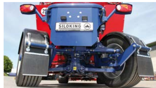
Standard u SILOKING SelfLine Premium 2215-22: profesionální nezávislé uložení kol má vysokou nosnost a je velmi odolné potřebování.
