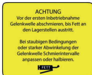
Obr.: Nálepka na kloubovém hřídeli
