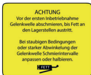
Obr.: Nálepka na kloubovém hřídeli
