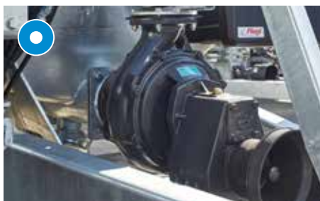
Rotační čerpadlo k provedení překládky
