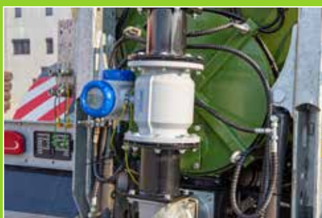
Průtočné množství během aplikace je měřeno indukčně pomocí digitálního průtokoměru Optiflux 2300 výrobce Krohne.
