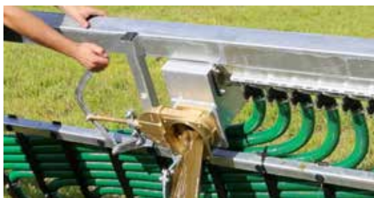
Úložný box na cizí tělesa mechanické nebo hydraulické vyprazdňování
