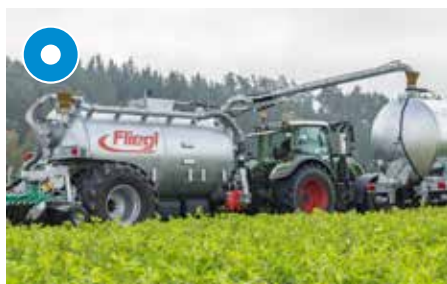
Hydraulické otočné sací rameno 8"
