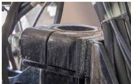
Osa uložena centrálně, hydraulické řízení pro jízdu s přesazením stopy
