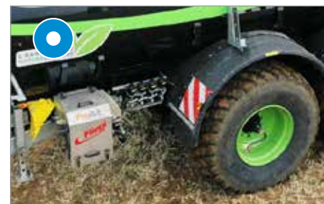
Systém regulace tlaku v pneumatikách
