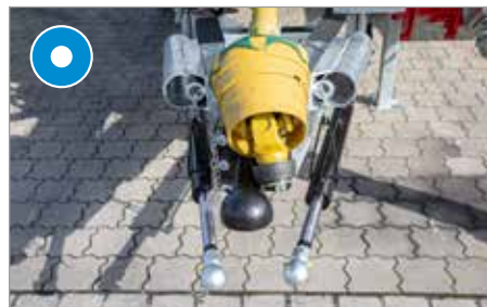
Nucené řízení hydraulické nebo elektronické
