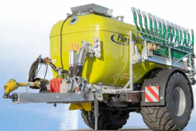
PFW Poly Line 9000 Čerpadlo s otočným pístem
