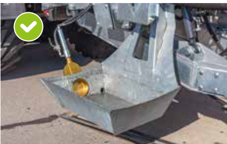
Sběrná vana pro sací výložník Transfill s automatickým vyprázdněním na poli
