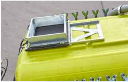
Posuvné víko 600 x 600 mm pneumatické nebo hydraulické
