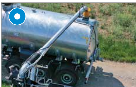
Pouze pro cisterny s čerpadlem: Odsávací výložník 8", délka 5 m
