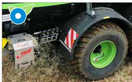
Systém regulace tlaku v pneumatikách
