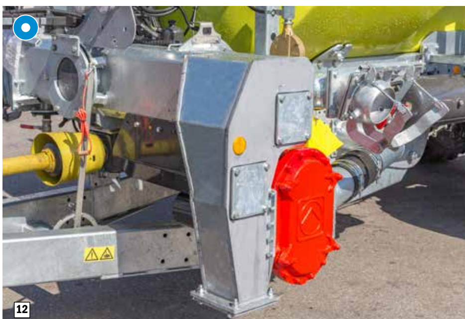
Čerpadlo s otočným pístem Obrazový materiál: Vogelsang GmbH & Co. KG, 49632 Essen/Oldb.
