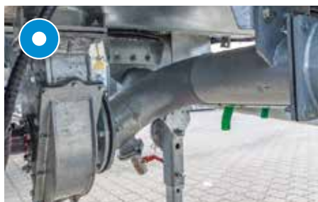
Turboplňení hydraulické, uprostřed pod cisternou
