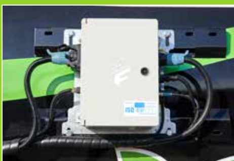
Rozvaděč FFC s integrovaným počítačem úloh a rozhraním ISOBUS
